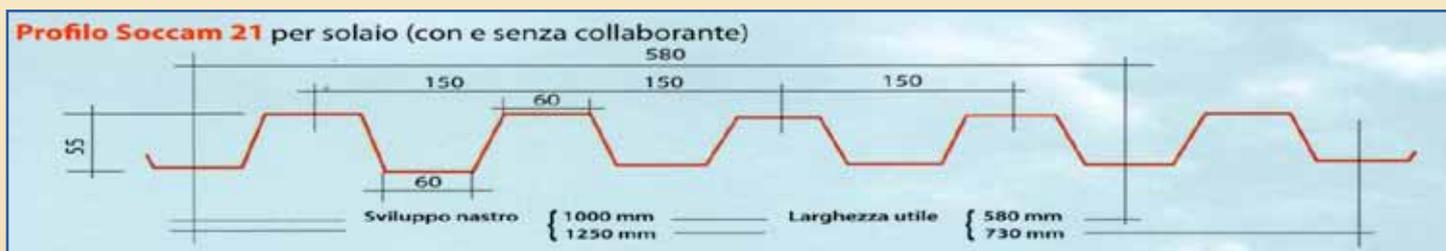
Le lamiere grecate sono realizzabili in lamiera zincata, preverniciata nei colori ral standard, in alluminio naturale e preverniciato, in acciaio inox, e in rame, negli spessori che vanno da 5/10 a 12/10.
